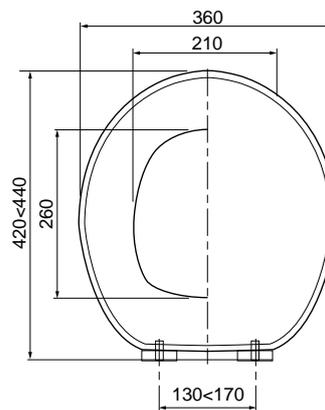
L'abattant AMIRAL est un abattant thermodur en D au design fin et moderne. Le thermodur est un matériau procurant de nombreux avantages : naturellement antibactérien, extrêmement résistant aux rayures et aux produits chimiques. L'abattant AMIRAL est compatible avec une large gamme de cuvettes en D.
