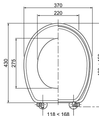
L'abattant WOODY est fabriqué en MDF et présente de beaux designs imprimés, fabriqués en France. Ses matériaux sont solides et confortables. L'abattant WOODY présente une forme ronde universelle s'adaptant à toutes les formes de cuvettes standards. Les charnières sont réglables afin de centrer l'abattant au millimètre près ! Et les fixations sont en inox pour éviter la corrosion.
